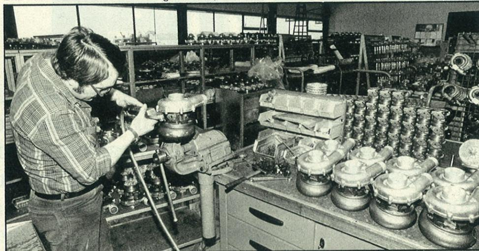
Endmontage bei KKK, 150 000 Turbolader entstehen jährlich in Einzelfertigung
