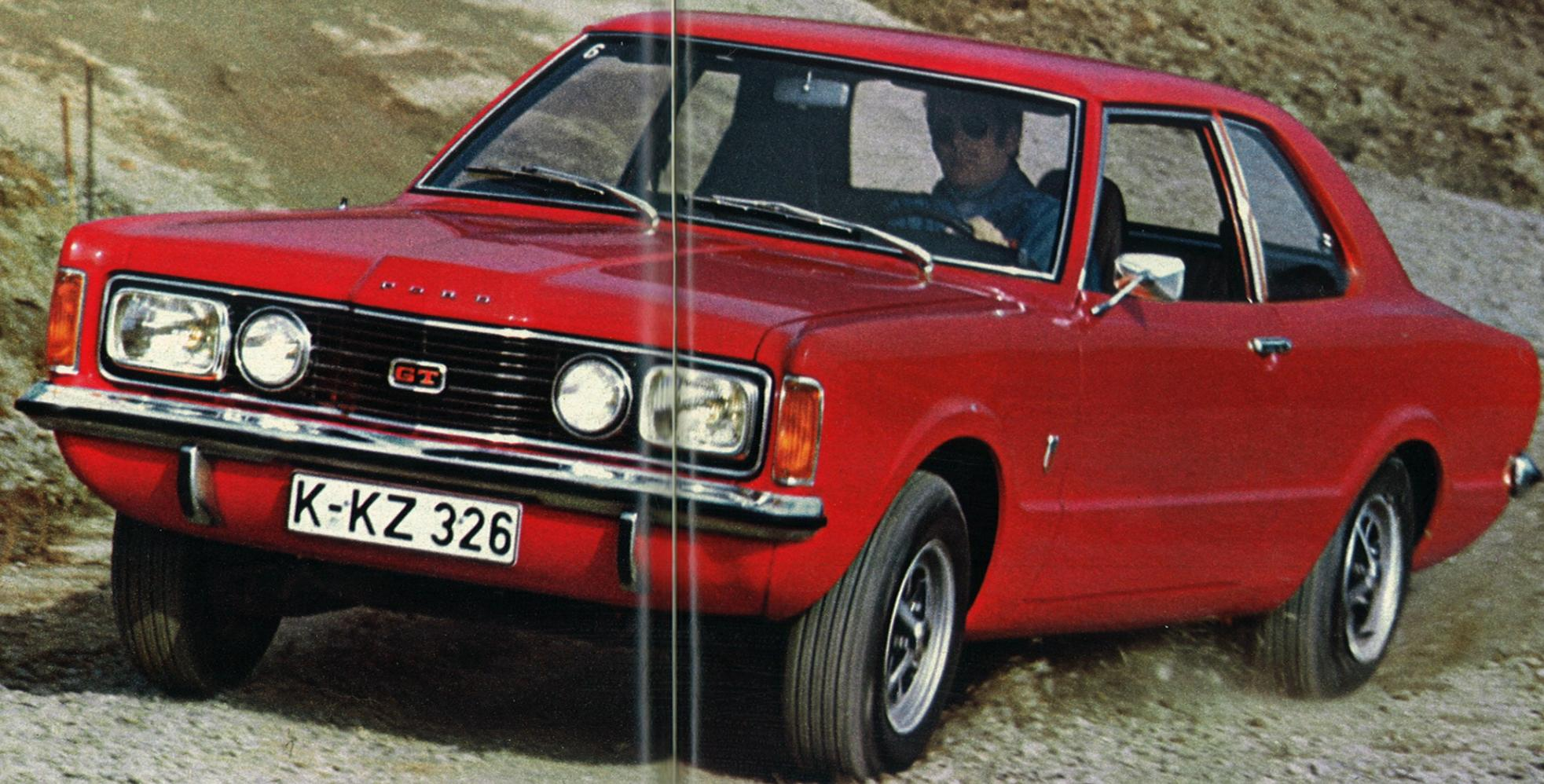
Der 1,6 Liter große Reihen-Vierzylinder ist in zwei Versionen, mit 72 und 88 PS, lieferbar. Die im Foto gezeigte stärkere Ausführung, die im GT-Modell serienmäßig ist, bezieht ihr Gemisch durch einen Weber-Registervergaser mit Startautomatik. Der Antrieb der obenliegenden Nockenwelle erfolgt durch Zahnriemen.
